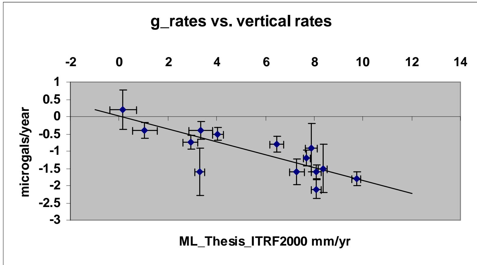
Slope  $-0.187 \pm 0.026 \mu\text{gal/mm}$  (1-sigma)
