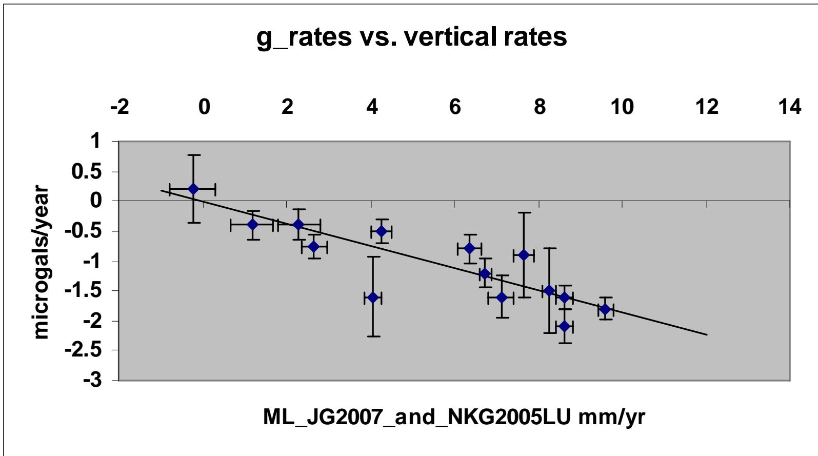
Slope  $-0.185 \pm 0.025 \mu\text{gal/mm}$  (1-sigma)
