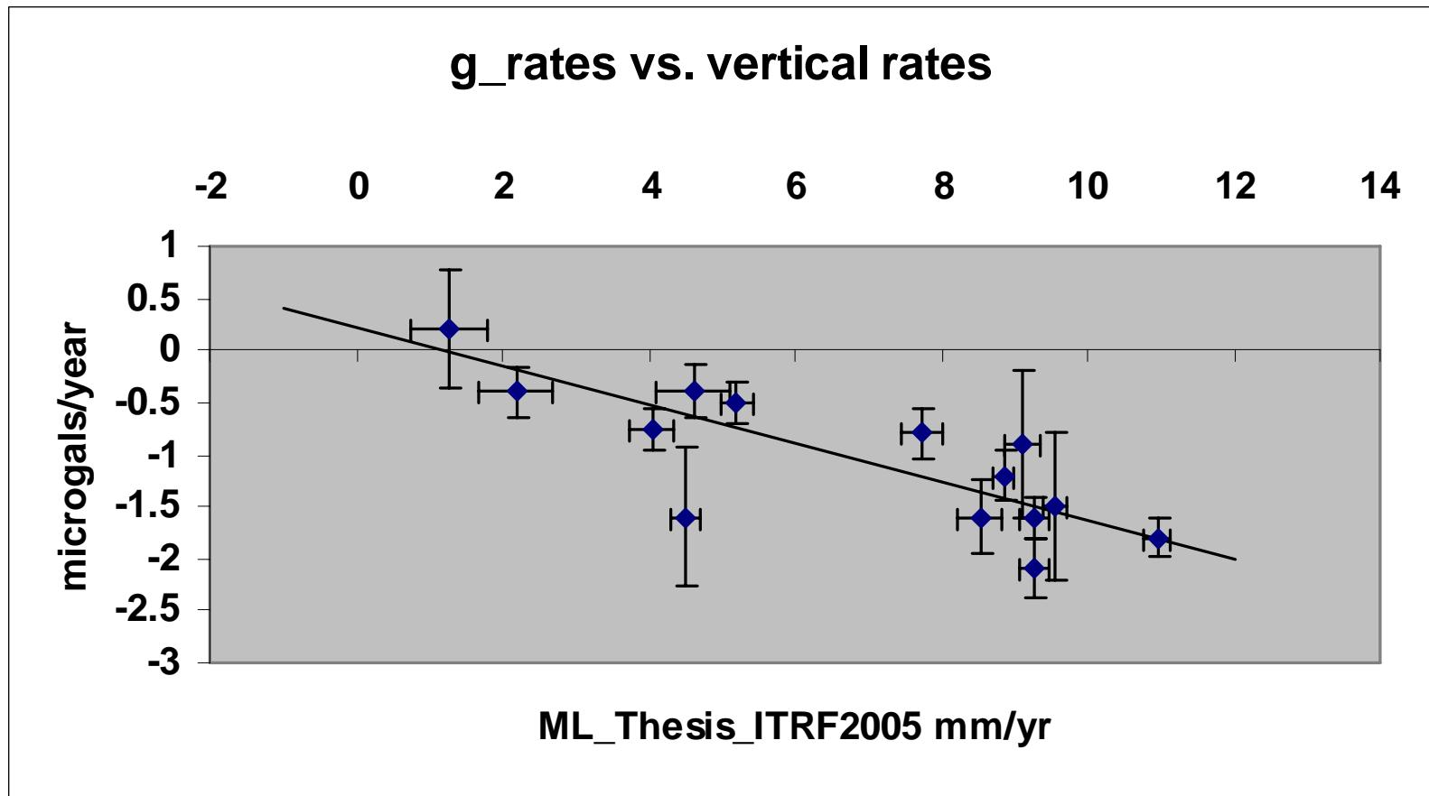
Slope  $-0.185 \pm 0.025 \mu\text{gal/mm}$  (1-sigma)
